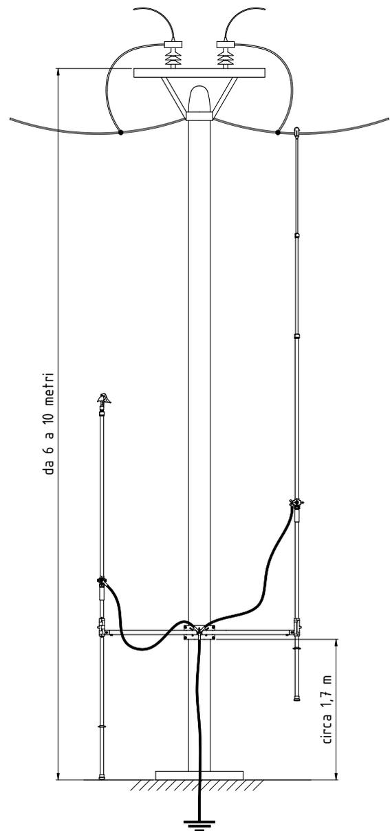
**FUSIBILE CERAMICO 2A/3kV COMPLETO DI SUPPORTI PER CIRCUITI
