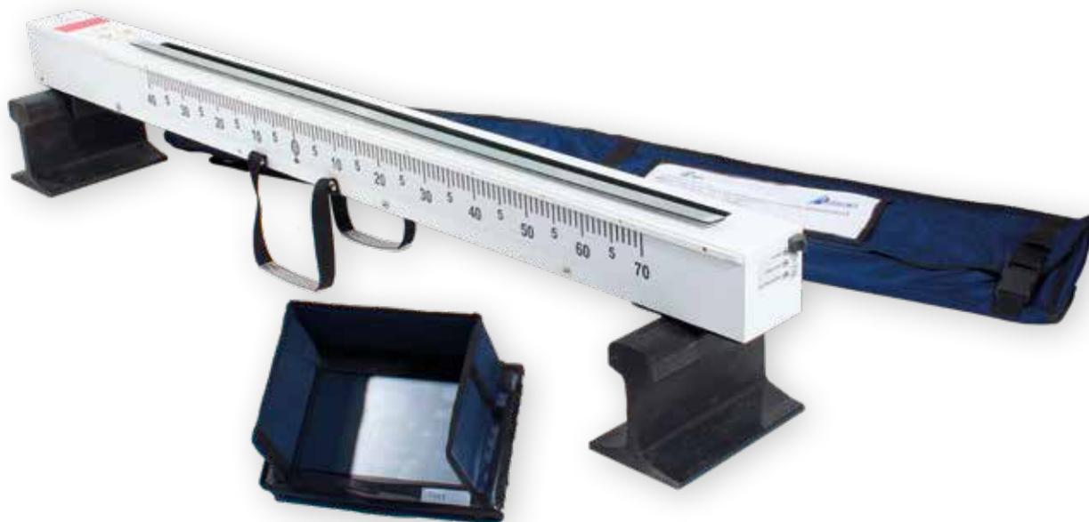
**Misuratore ottico / meccanico** per altezza e poligonazione della catenaria della linea di contatto, lettore laser - misuratore automatico
