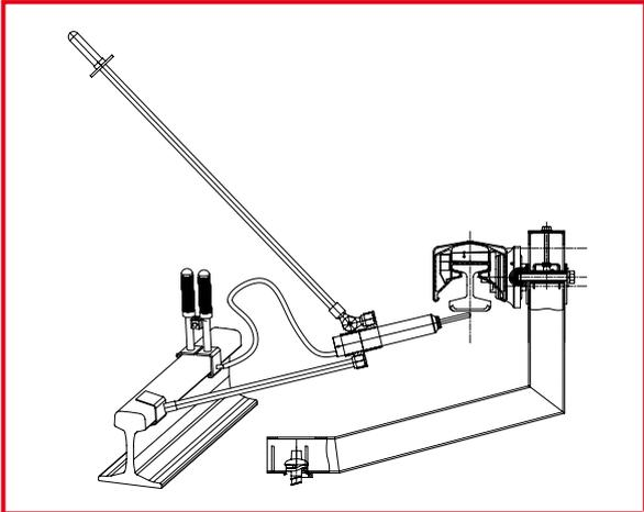
**Rivelatore di tensione bipolare 75 Vcc ÷ 1500 Vcc**
