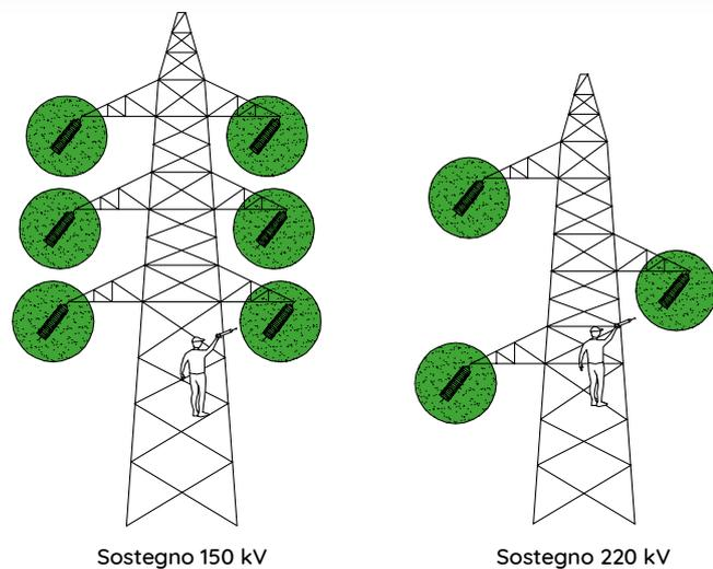
Verifica di assenza di tensione in sostegni tronco piramidali
