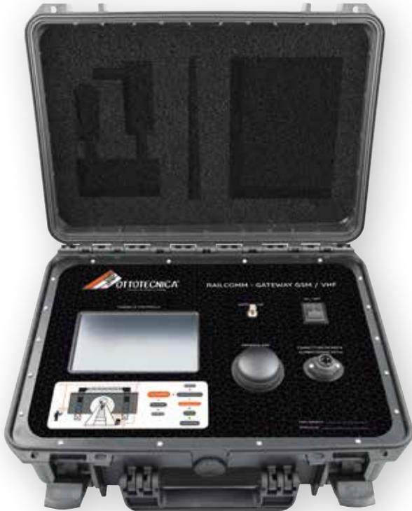
Il dispositivo è un'interfaccia in grado di effettuare la comunicazione verso l'interno di una galleria o cantiere di qualsiasi lunghezza.
